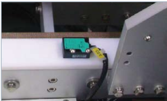
ML8-8-H med tre ljusfläckar identifierar kretskort på ett säkert sätt, även med en ljus bakgrund på nära håll
